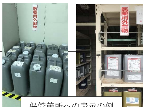
保管箇所への表示の例
